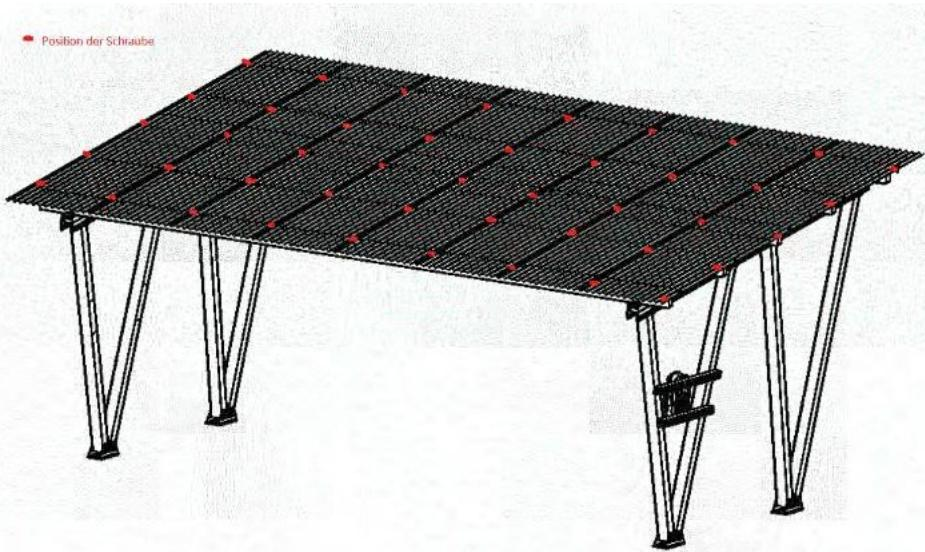
Jedes Metalldachblech muss an den Enden weitestgehend befestigt und bündig ausgerichtet werden. Wiederholen Sie die obigen Schritte, um das gesamte Blechdach zu installieren.
